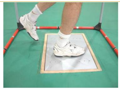
این دستگاه با توجه به نیروهای اعمالی بر صفحه آن، نیرو را به سه راستای عمود بر هم ۴<sub>۷</sub>،F<sub>۲</sub> و F<sub>z</sub> ، تجزیه می کند. علاوه بر این سه خروجی، به کمک نرمافزار می توان مقادیر زیر را نیز اندازه گیری کرد:
