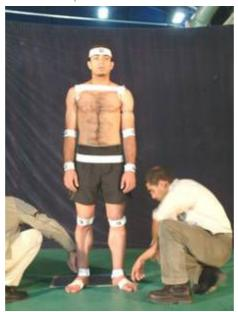
پس از قرارگیری نشانگرها بر روی مفاصل، از حرکت ورزشکار با دوربین هایی با سرعت بالا فیلمبرداری می شود. سپس بر روی تصاویر فرآیندهای ویدئویی صورت می گیرد و تصاویر نهایی به نرم افزار تحلیل حرکت وارد می شوند. این نرم افزار با دنبال کردن نشانگرها، اطلاعات سینماتیک حرکت را استخراج می کند.
